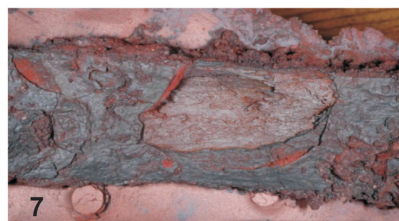
Ryc. 10. Nawarstwienia korozyjne na kotle i rodzaje zniszczeń (fot. J. Strobin)
